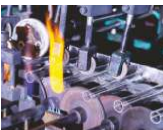
TEST TUBE MACHINE: 40000 PCS PER SHIFT
